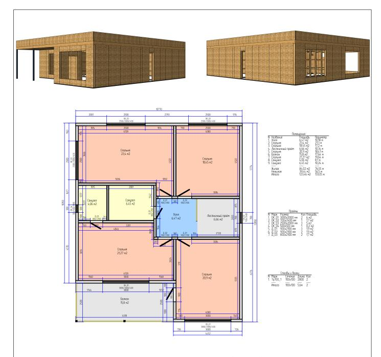
Надстройка второго этажа из СИП-панелей 174 мм высотой 2800 мм (ОСП+ОСП) на существующий первый этаж с железобетонным межэтажным перекрытием. Общая площавь монтажа — 138,39 кв.м.
