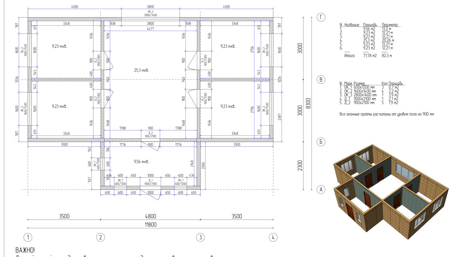
Данный чертёж предоставлен исключительно для согласования размеров. Домокомплект будет изготовлен только из СИП-панелей и стоек к ним. Окна, двери и внутренние стены в домокомплект не входят. Однако, по желанию Клиента, внутренние стены тоже могут быть из СИП-панелей.
