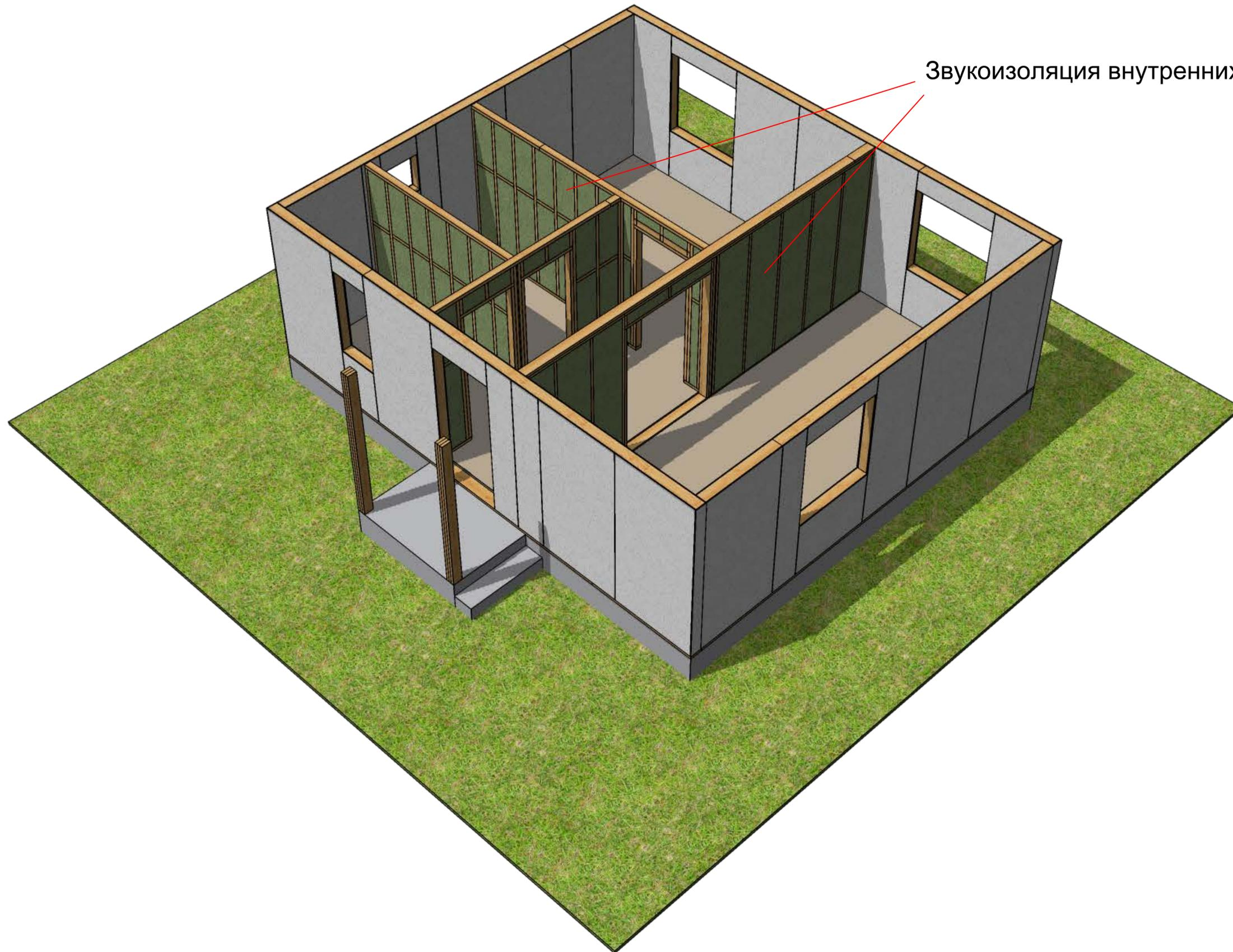
Звукоізоляція внутрішніх стін і перегородок
