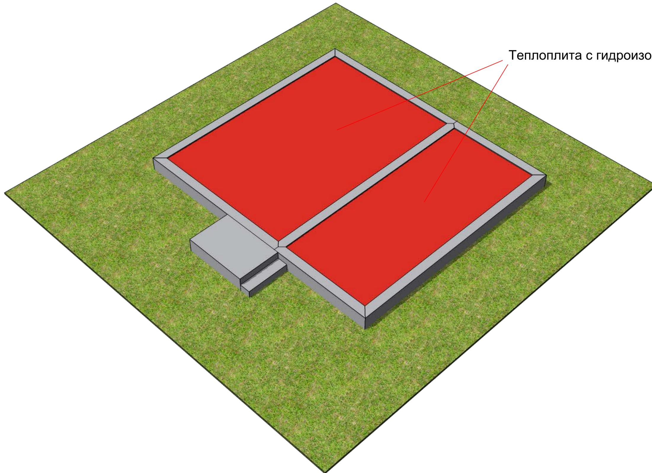
Теплоплита с гидроизоляцией
