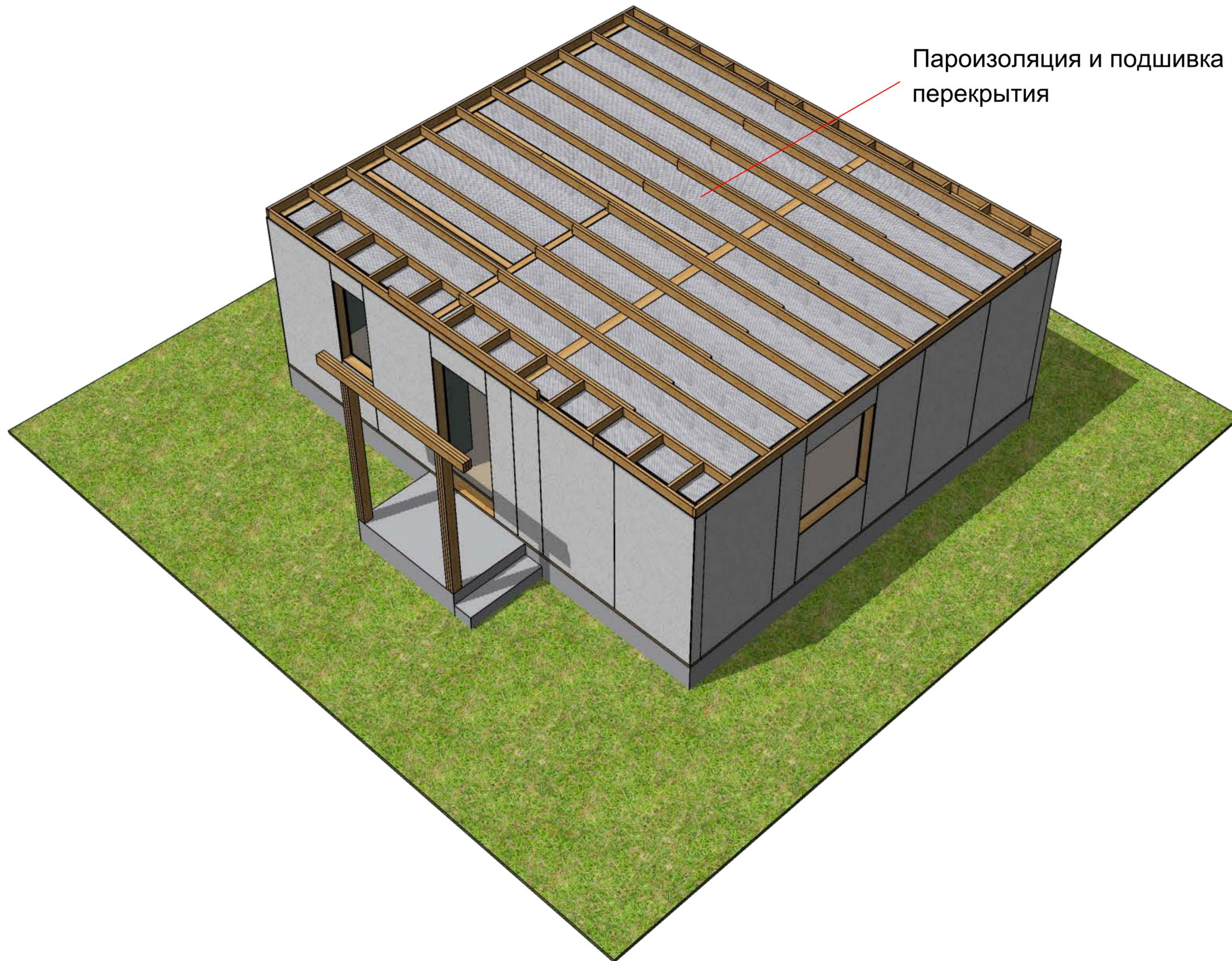
Пароизоляция и подшивка потолка чердачного перекрытия
