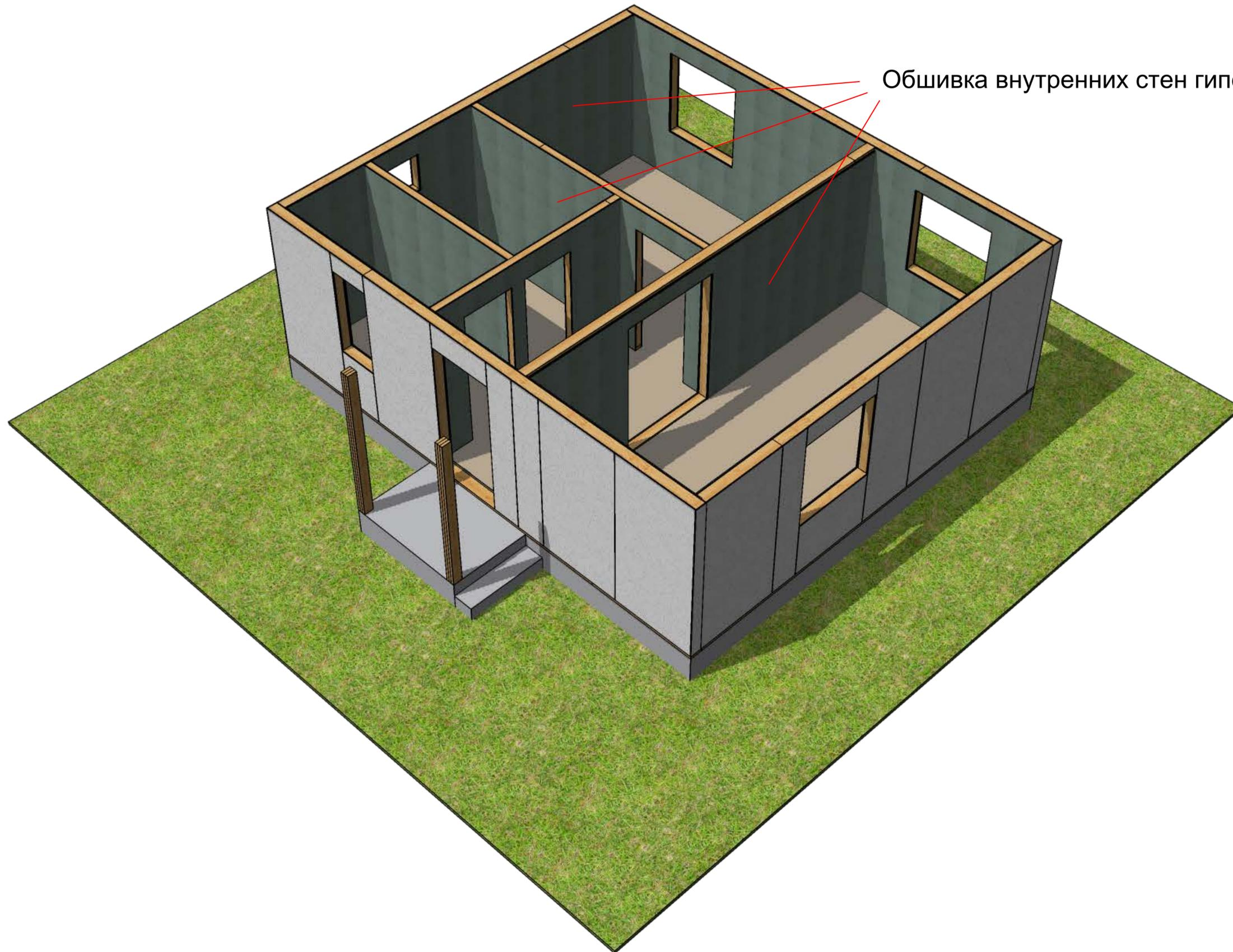
Обшивка внутренних стен гипсокартоном
