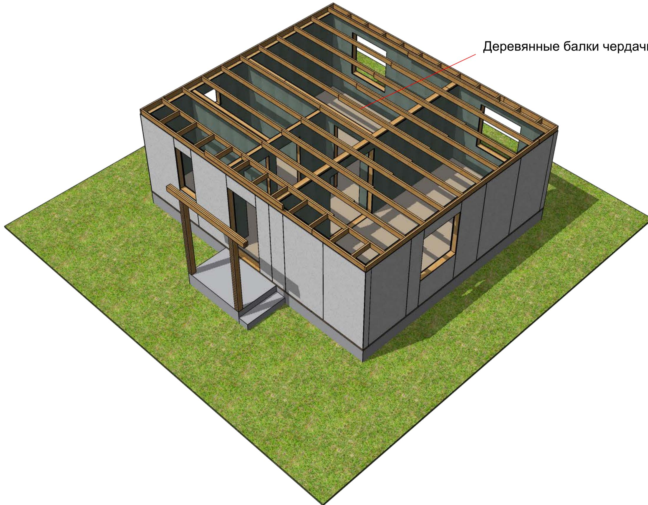
Деревянные балки чердачного перекрытия
