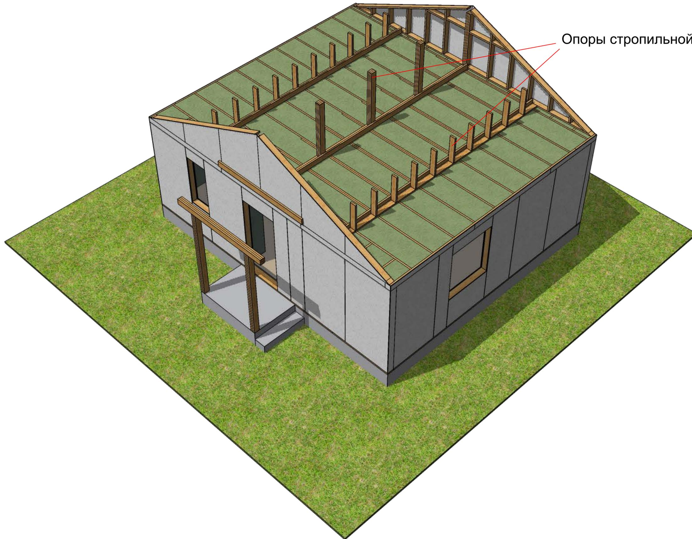
Опоры стропильной системы
