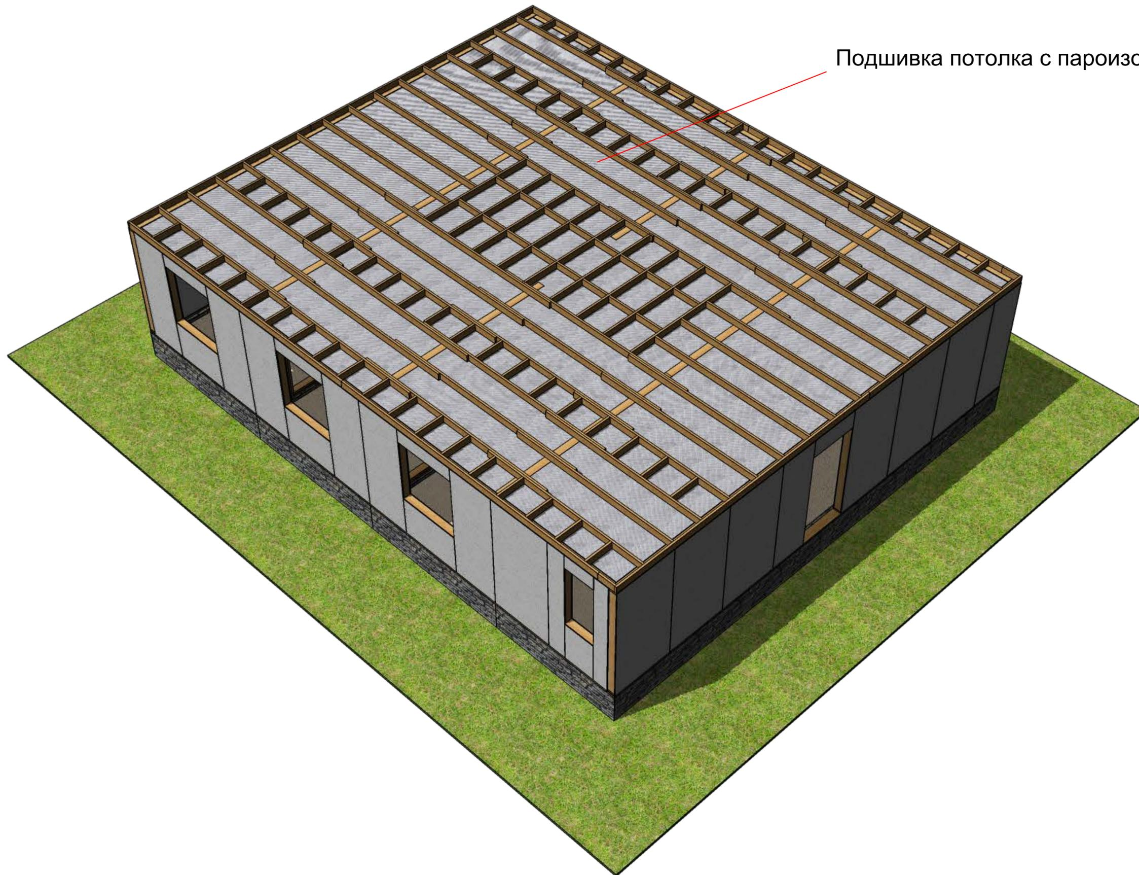
Подшивка потолка с пароизоляцией
