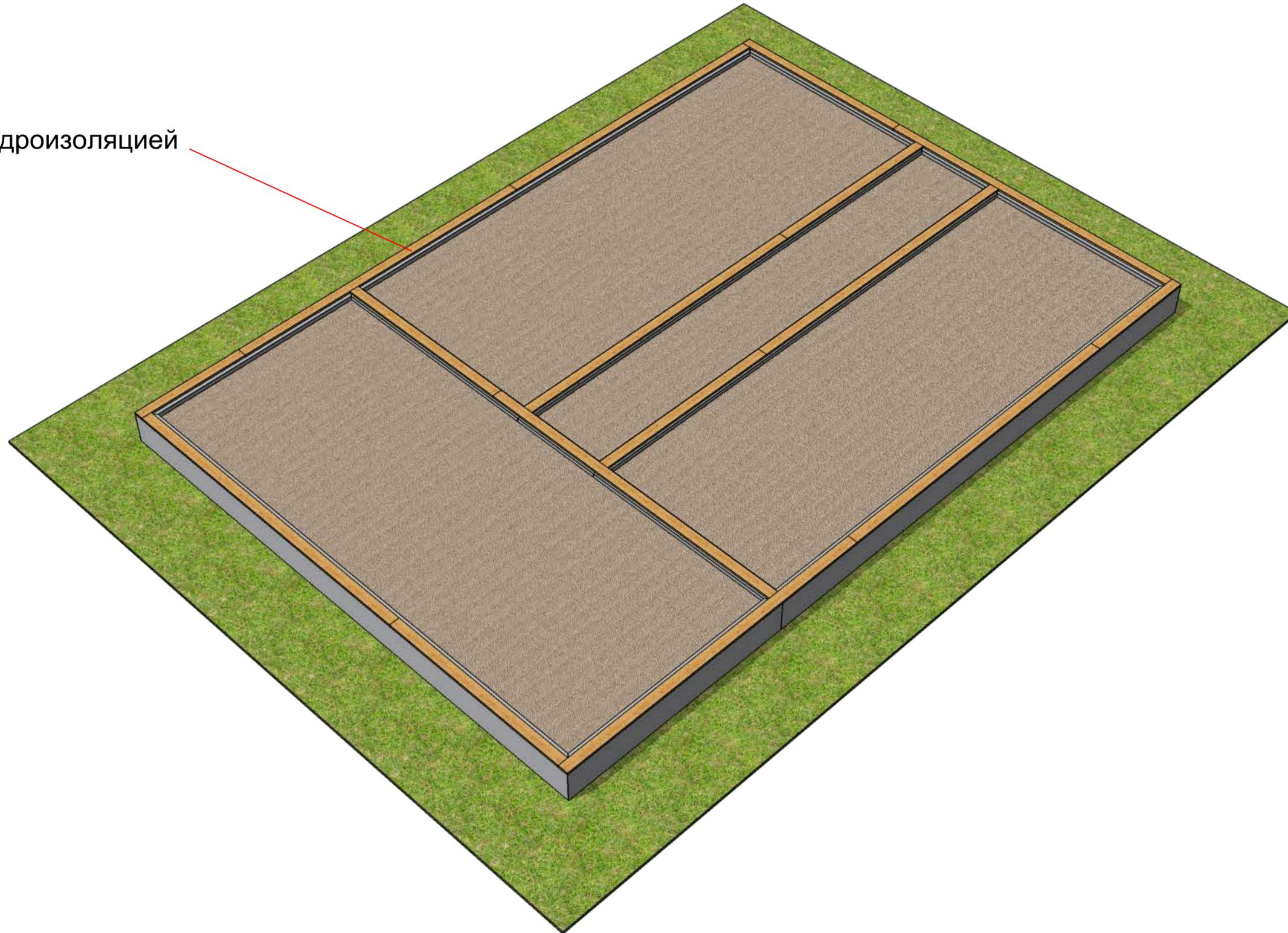
Деревянный каркас внутренних несущих стен
