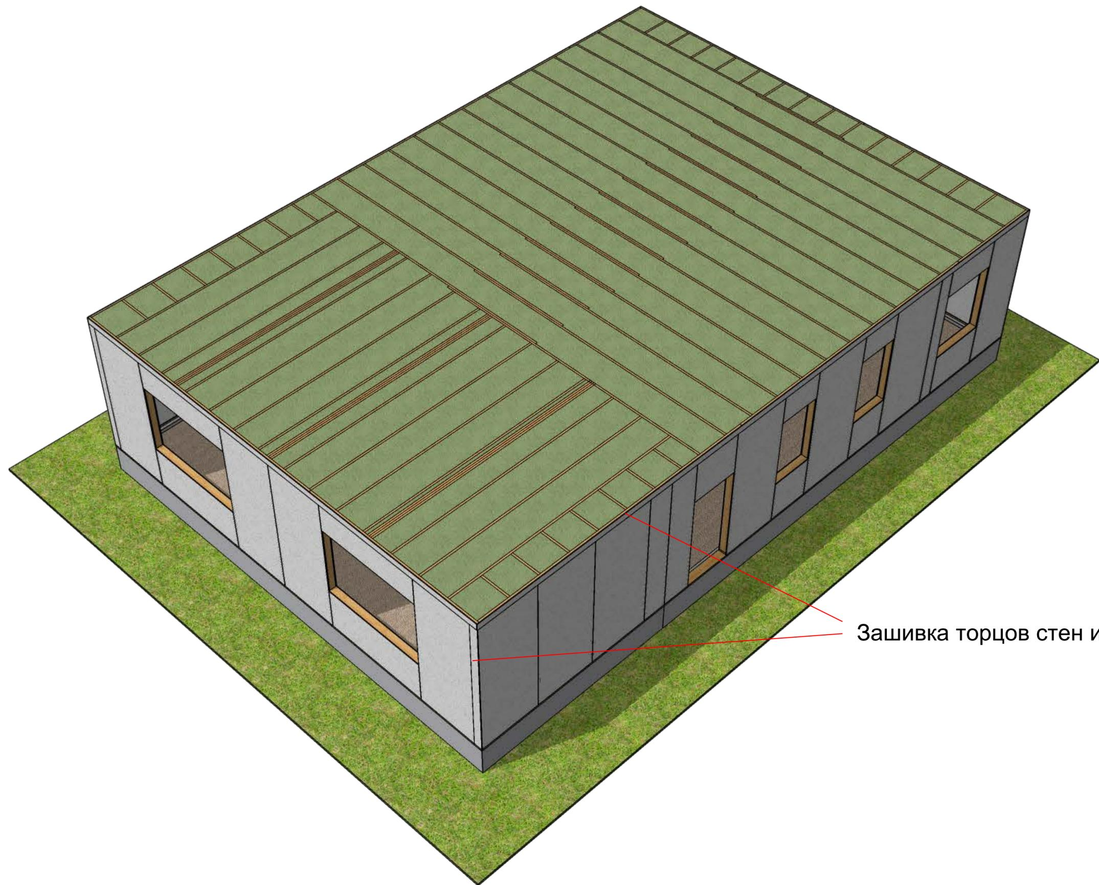
Зашивка торцов стен и чердачного перекрытия
